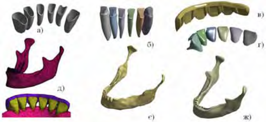
Рис. 2. Структурні твердотільні елементи моделі біомеханічної системи щелепи з вестибулярно розташованою вінірною шиною та дискретним відображенням моделі ЗПЩВШ
