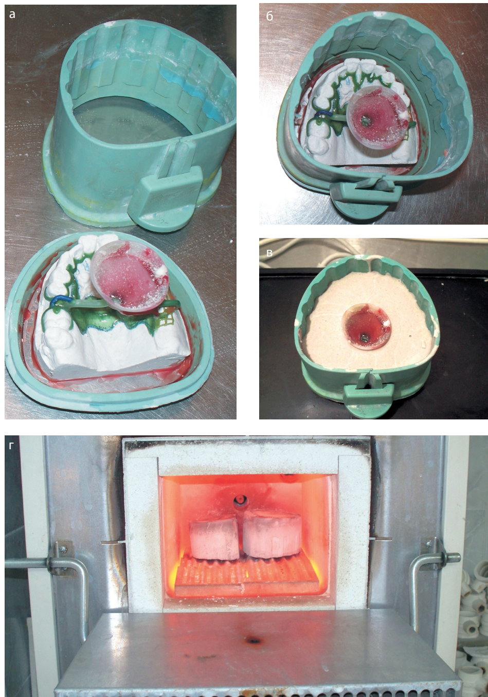
Мал. 57. Формування каркаса бюгельного протеза та випал в муфельній печі: а) підбір опоки відповідного розміру; б) встановлення вогнетривкої моделі із восковою репродукцією в опоку; в) формування опоки, час твердіння пакувальної маси 30 хв.; г) муфельна піч для випалу опок
