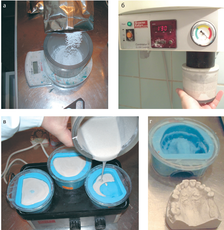
Мал. 54. Виготовлення вогнетривкої моделі:
