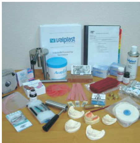
Мал. 103. Ручний інжекторний пристрій, стоматологічний нейлон та аксесуари для виготовлення нейлонових протезів
