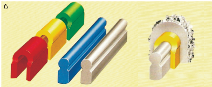
Мал. 94. Снеп-балка, два типи фіксації вторинної конструкції на снеп-балці (з двосторонніми пазами) («bredent»): а) фрикційна снеп-фіксація; б) шарнірна снеп-фіксація
