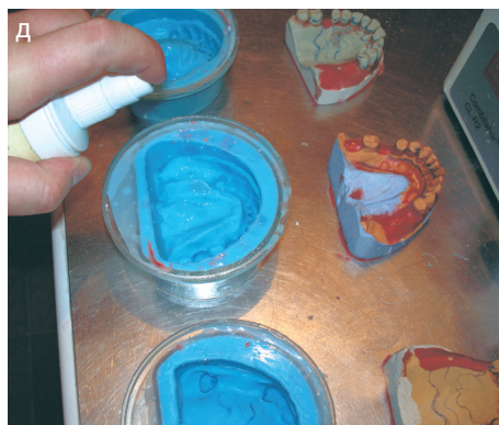
Мал. 53. Дублювання силіконовою масою: а) приготування силіконової дублюючої маси; б) підготовлені гіпсові моделі встановлені в дублюючі кювети; в) заповнення кювети дублюючою масою; г) готова силіконова форма; д) рідина Ауорофільм усуває водовідштовхувальний ефект силікону
