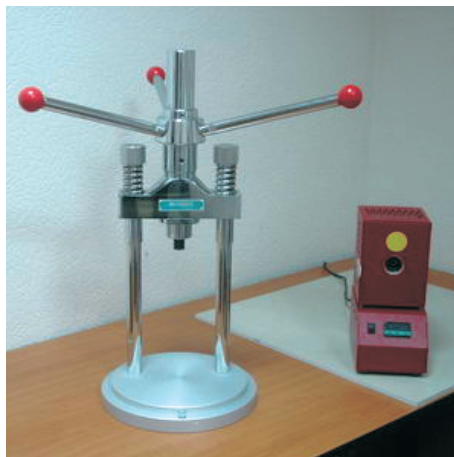
Мал. 103. Ручний інжекторний пристрій, стоматологічний нейлон та аксесуари для виготовлення нейлонових протезів
