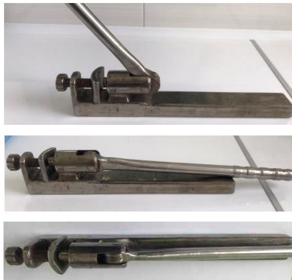
Рис. 5.14 Важільний пружинний згинач пластин власної розробки
