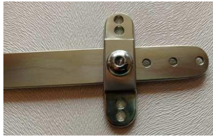
Рис. 5.16 З'ємний стабілізатор із двома отворами на кожному кінці фіксований гвинтом у четвертому отворі пластини
