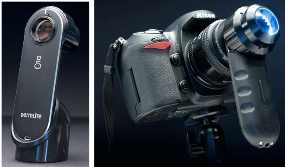
Рисунок 4.21. Оптичний дерматоскоп, який інтегровано з цифровою фотокамерою 25
