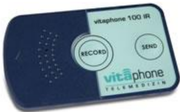
Рисунок 6.3. Побутовий прилад для знімання ЕКГ в 1-му відведенні (для фіксації ЕКГ в 1-му відведенні досить прикласти прилад до грудної клітки в потрібній точці) 33
