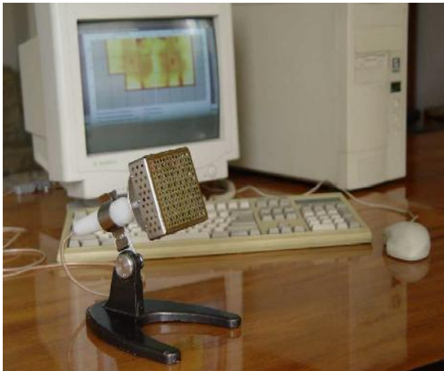
Рисунок 7.4. Цифровий контактний термомамограф для телескринінгу злякиснених новоутворень молочних залоз 43
