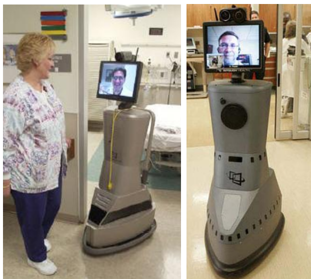
Рисунок 8.3. Абонентський термінал системи телеприсутності на роботизованому шасі 47
