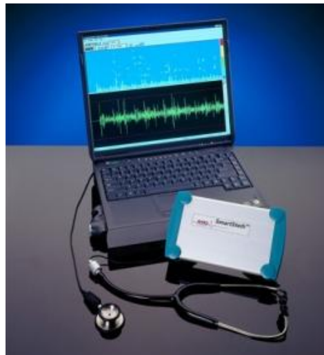
Рисунок 4.10. Цифровий стетоскоп з телемедичними функціями (реальночасова трансляція аускультативної картини й/або фіксація її у вигляді комп'ютерних файлів) 14
