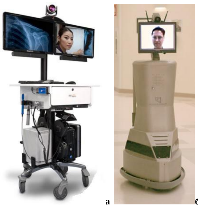
Рисунок 5.9. Мобільні комплекси для відео-конференц-зв'язку: а - пересувна станція, б - пересувна станція на роботизованому шасі 28
