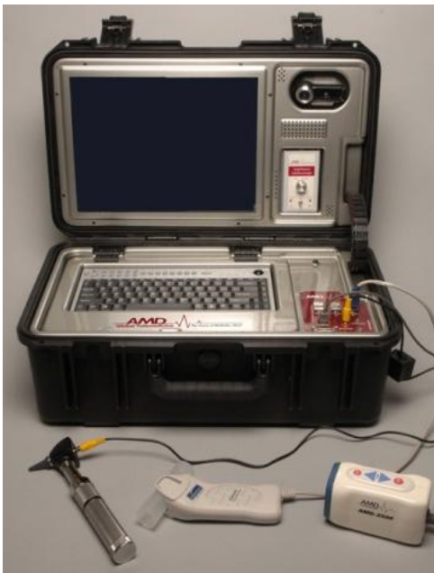
Рисунок 4.1. Мобільний телемедичний комплекс (модифікація 2), який містить електронну медичну картку пацієнта, програмні засоби відеоконференц-зв'язку, телемедичну камеру для загального обстеження, 12-канальний ЕКГ-телеметричний пристрій, діагностичне обладнання з телемедичними функціями – цифровий отоскоп, цифровий спірометр, цифровий стетоскоп 5
