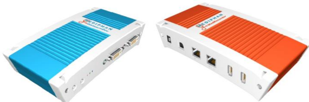
Рисунок 8.9. Пристрої захоплення зображень для медичної апаратури з візуалізацією (електронно-оптичних перетворювачів (ЕОП), ендоскопів, ультразвукових сканерів і т.д.) – ключовий компонент пасивних систем телеасистування 51
