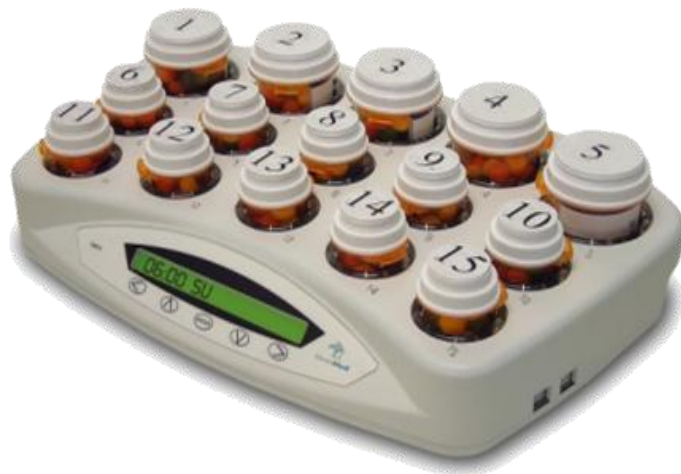
Рисунок 6.5. Прилад для керування (медикаменти розсортовані по контейнерах; відповідно до програми прилад сповіщає пацієнта про необхідність прийому потрібної кількості таблеток з потрібного контейнера) і контролю (якщо пацієнт багаторазово пропустив прийом медикаментів прилад автоматично сповіщає call-центр про можливу недієздатність підопічного) 34
