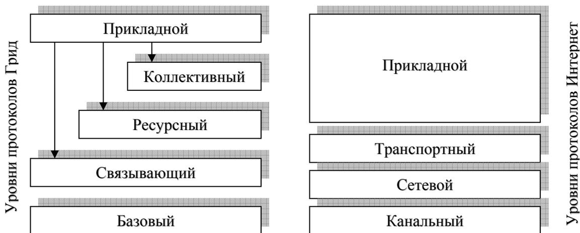
Рис. 1. Уровни архитектуры протоколов Грид и их соответствие уровням архитектуры протоколов Интернет
