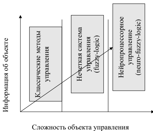
Рис. 5.2. Схема управления в зависимости от сложности объекта и количества существующей информации о нем
