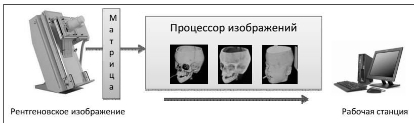
Рис.4.12. Схема построения рентгеновского комплекса с цифровым терминалом
