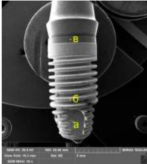
Рис. 2. Внешний вид имплантата AnyOne: а, б, в — зоны морфологического и химического анализа
