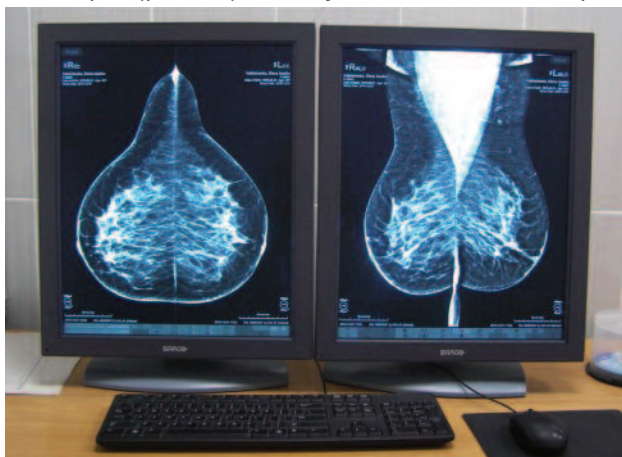
Рис. 5. Робоча станція рентгенолога з 2 монохромними 5-мегапіксельними моніторами
