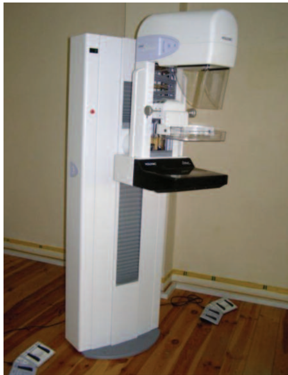
Рис. 6. Цифровий мамограф з приймачем, який має робоче поле 24×30 см
