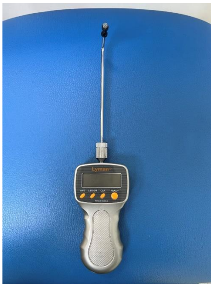
Рис. 2.7. Динамометр Lyman Trigger Pull Gauge виробництва США
