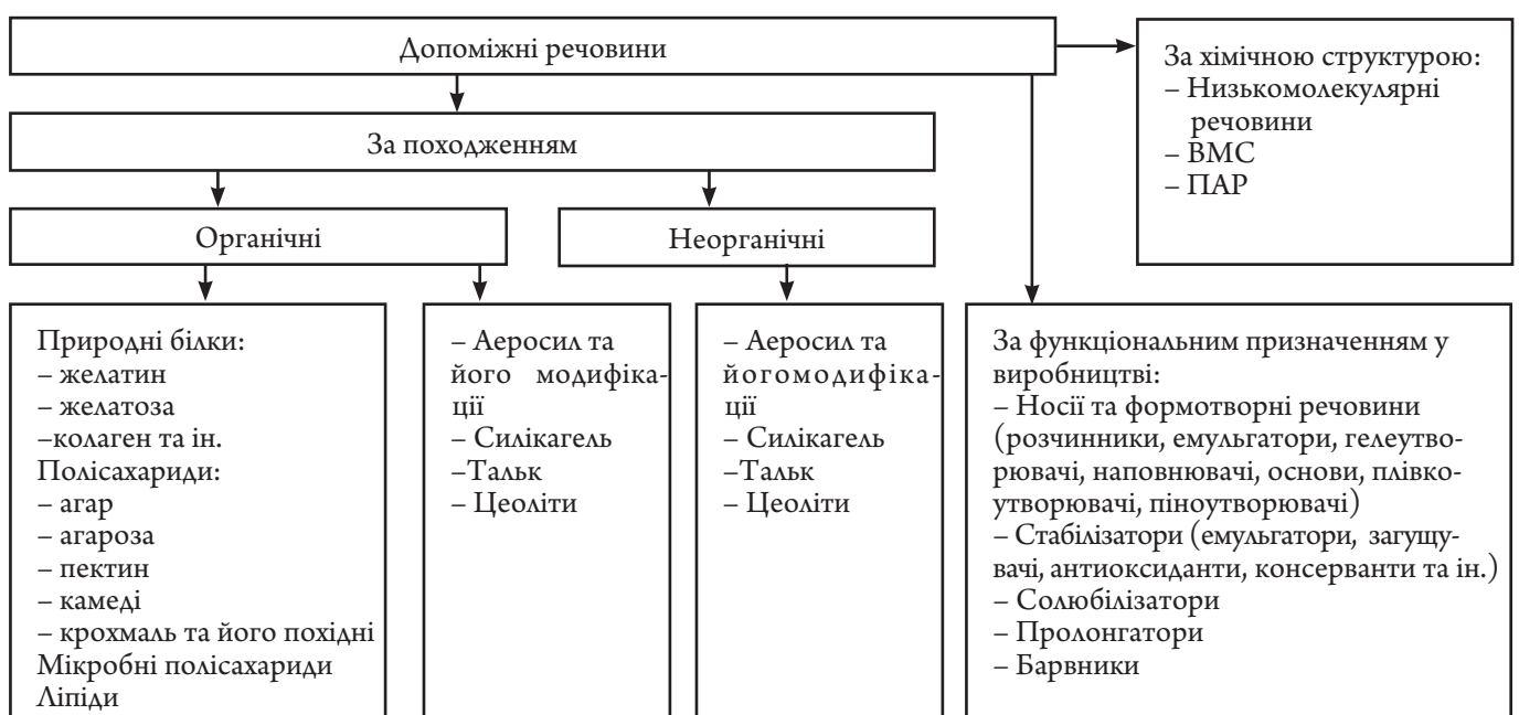
Рис. 1. Класифікація Е за походженням, хімічною структурою та їх функціональним призначенням у виробництві ЛЗ [6].
