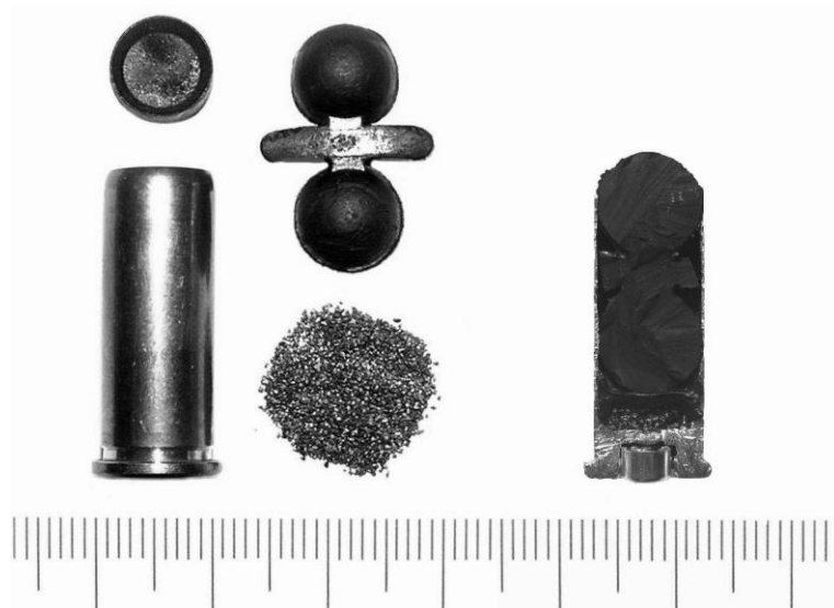
Рис. 64. Компоненти патрону “Оса” (гільза з капсулем, пороховий заряд, пиж та куля) після демонтажу (ліворуч) та вигляд патрону на повздовжньому зрізі
