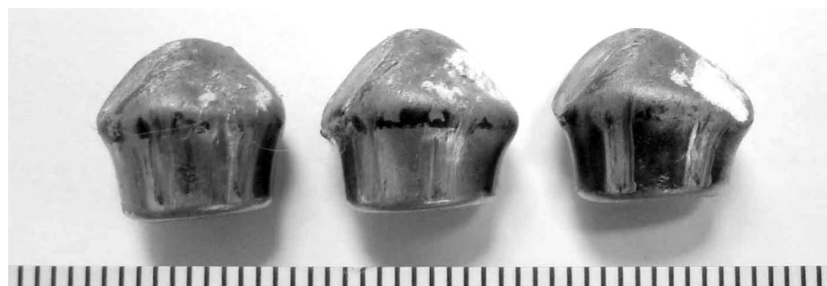
Рис. 72. Форма куль при ударі їх об перешкоду під кутом близьким до 30°.
