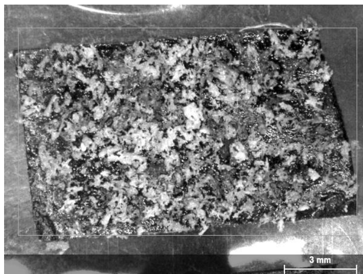
Рис. 105. Незгорілі порошинки великих розмірів на площині сканування продуктів пострілу на поверхні вуглецевого скотчу, що утворилось при пострілах з пістолету «Форт 17» з прямокутною формою нарізу ствола патронами 9x18мм ПМ з відстані 4 м. РФСА.
