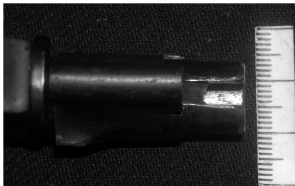
Рис. 87. Фрезевий пропил, що розташований на нижній поверхні ствола револьверу серії ЯЗ № 612
