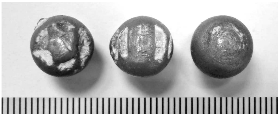
Рис. 74. Сліди на передніх частинах куль при їх проходженні через загартоване бокове автомобільне скло під кутом близьким до 80^\circ в наступній послідовності: справа – перша, в центрі – друга, зліва – третя
