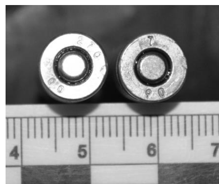
Рис. 304. Зовнішній вигляд наданих на дослідження боєприпасів 5.45x39 (холостий) АЕ-16.
