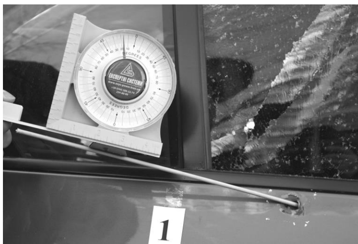
Рис. 227. Вимірювання кута під яким зроблено постріл з допомогою транспортиру
