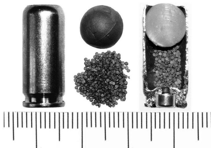
Рис. 65. Компоненти патрону “ПНД-9П” (гільза з капсулем, пороховий заряд та куля) після демонтажу (ліворуч) та вигляд патрону на повздовжньому зрізі
