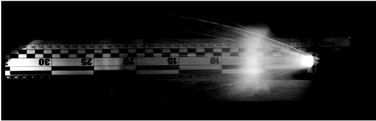
Рис. 15. Поширення полум'я пострілу з пістолета «Глок 19» з використанням патрону 9×19 мм «Парабеллум» (NONTOX)
