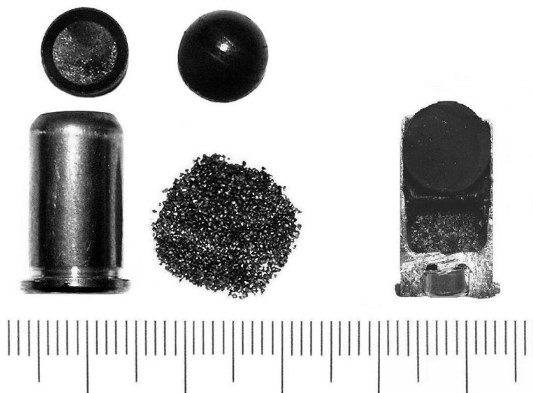
Рис. 66. Компоненти патрону “АЛ-9Р” (гільза з капсулем, пороховий заряд, пиж та куля) після демонтажу (ліворуч) та вигляд патрону на повздовжньому зрізі
