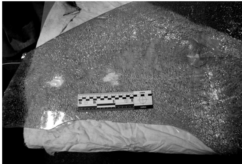
Рис. 71. Сліди вогнепальних пошкоджень на загартованому автомобільному склі праворуч – перше, в центрі – друге, ліворуч - третє.
