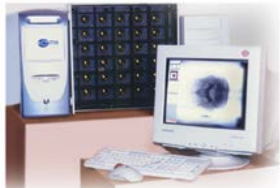
Перший серійний 30-сенсорний детектор «Альфа-В2500» для переведення на цифрову технологію флюорографіє
