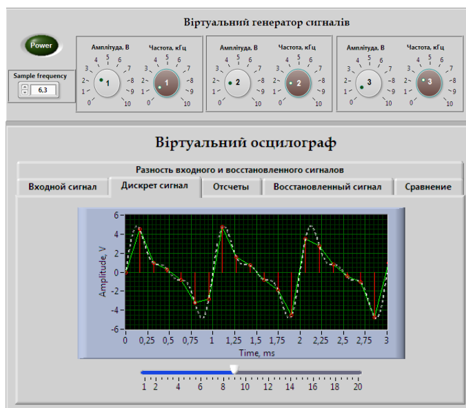
Рисунок 1. Інтерфейси користувача вимірювальних віртуальних приладів: генератора сигналів і осцилографа
