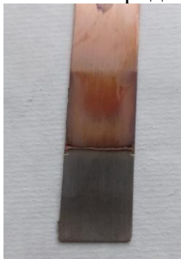
Рисунок 2. Фотография покрытия с включением TiO_2 : ( NiSO_4 \cdot 7H_2O -300 г/л, NiCl_2 \cdot 6H_2O – 60 г/л, H_3BO_3 - 30 г/л; TiO_2 - 10г/л; i=200 А/м 2 ; \tau=1 час.
