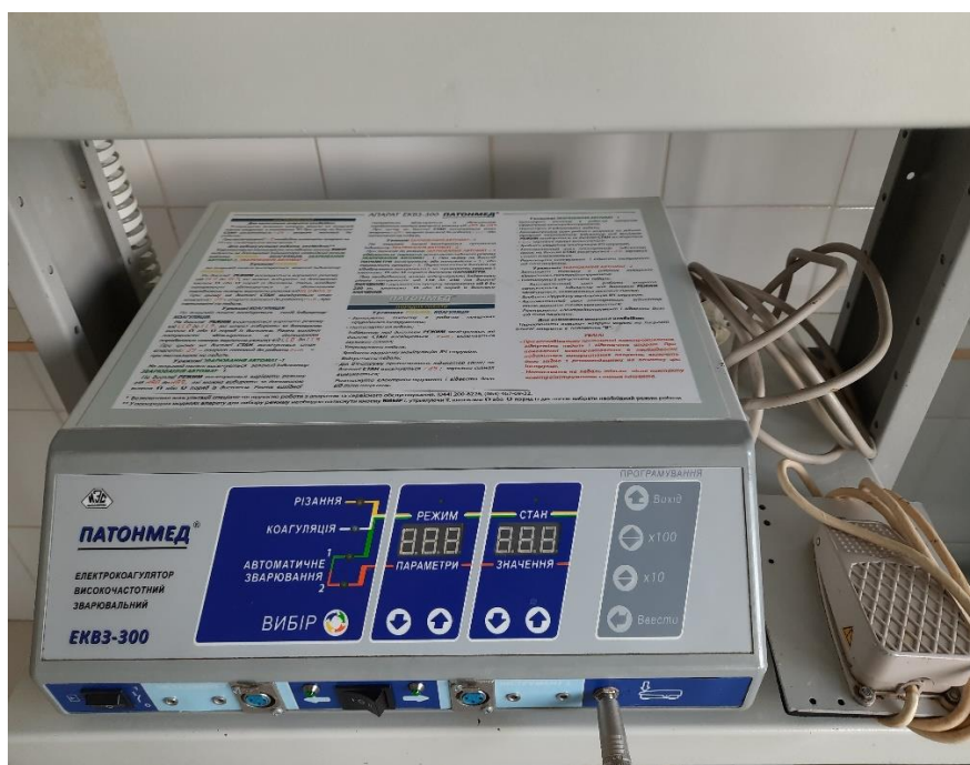
Рисунок 1. Багатофункціональний апарат високочастотний зварювальний ЕКВЗ-300 «Патонмед»
