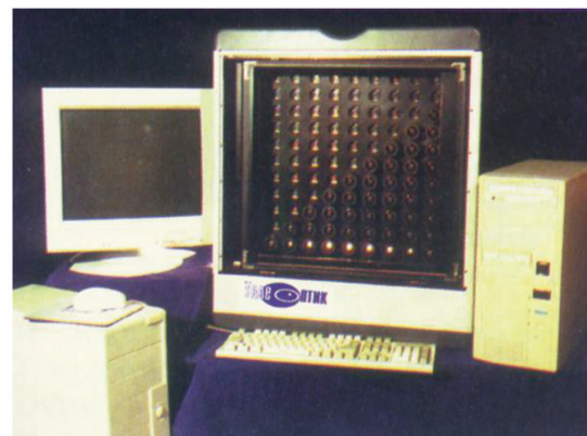
Рис. 3. Виготовлений в Україні 99-камерний цифровий рентгенівський приймач, який у 1997 році було продемонстровано на виставці RSNA в Чикаго
