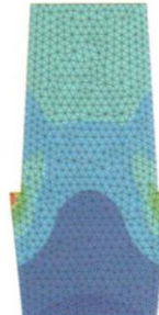
Рис. 9. Схема напружень, що виникають в абатменті з конусністю 7,5°.
