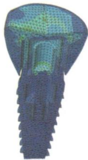
Рис. 5. Схема розподілу граничних напружень, які виникають у конструкції під дією жуваального навантаження (220 Н).
