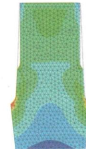
Рис. 11. Схема зменшення напружень створення додаткових ретенційних елементів покращення фіксації штучної коронки в абатменті, виготовленому за запропонованою методикою при навантаженні: а) 220 Н; б) 400 Н.
