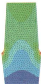
Рис. 10. Схема зменшення напруження в абатменті при уступі під кутом 137° з виконанням закрулення.
