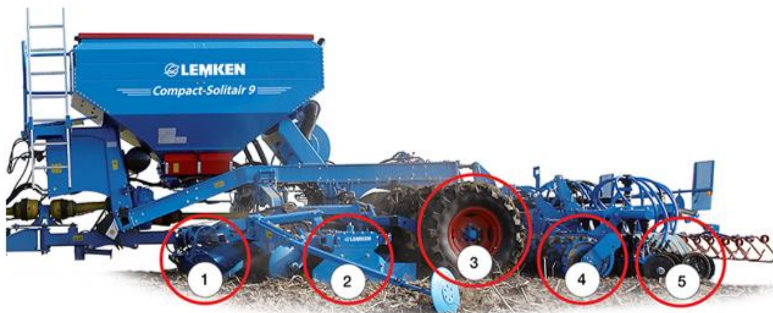
Рис. 2. Комбінований ґрунтообробно-посівний агрегат Compact-Solitaир 9/300H: 1 – надійне вирівнювання; 2 – оптимальна передпосівна підготовка; 3 – найкраще зворотне ущільнення: шинний прикочуючий коток; 4 – найкраще зворотне ущільнення: трапецієподібний прикочуючий коток; 5 – дводисковий сошник OptiDisc з прикочуючими роликками
