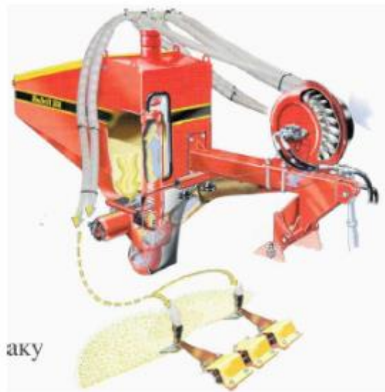
Рис. 5. Загальний вигляд ґрунтообробної комбінації Bio-Drill+Carrier фірми «Vaderstad» з пневматичною версією транспортування насіння до сошників
