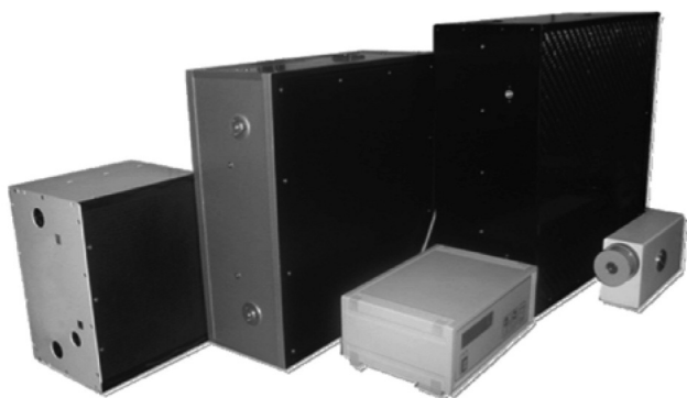
Рис. 1. Микрофокусный рентгенаппарат и цифровые приемники на решетке фото-диодных матриц
