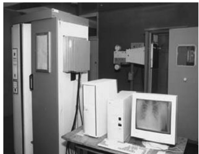
Рис. 1. Первый флюорограф, дооборудованный цифровым приемником «Альфа»
