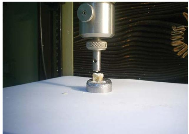
Рис. 3. Ілюстрація руйнації коронкової частини під дією навантаження. Випробувальна машина «TIRATEST-2151 № 19/89».
