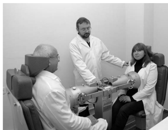
Рис. 1.11. Стаціонарні ЛВЛ «Скриннер-3М» (зліва) та «Super-Jemini» (справа)
